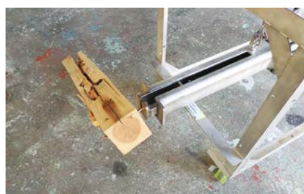
ボルトを引き抜く様子
