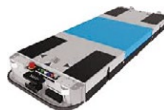
低床型自律走行搬送ロボット 「TAR」【立山マシン株】
