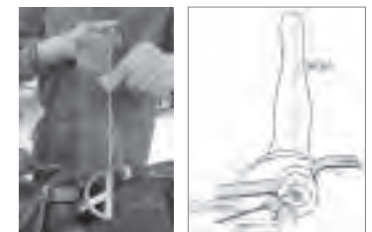
【図5】設置角度測定デバイス(左)と測定原理(右)
