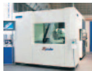
第5回ものづくり日本大賞 「経済産業大臣賞」受賞 ワンチャッキング6面加工の マシニングセンタ「MYCUBE」
