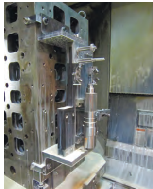
熱硬化CFRP 製クレードル面板 実加工試験写真
