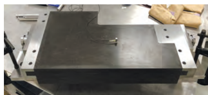
熱可塑CFRTP 製クレードル面板 振動減衰性試験写真
