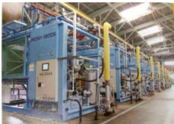
発泡プラスチックの生産ライン（会社パンフレットより）
