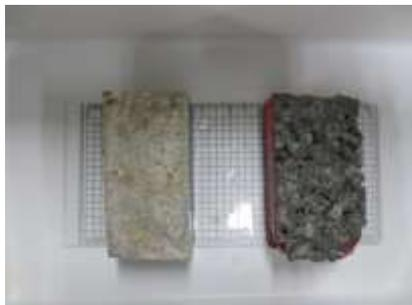
図 1 平板普通コンクリート（左）と FA 高含有ポーラスコンクリート（右）
